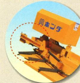
強靱な材質で出来ており、規則正しい運動で絶えずパドルに付着している汚物をきれいに取り除く役目をします。足場が無くてもメンテが簡単に出来ます。特に上下の調整がワンタッチ。
