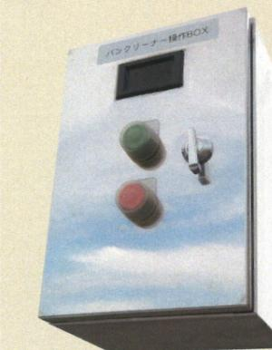
チェーンに異常な負荷がかかり、モーターに流れる電流が設定値を超えたとき、瞬時に停止する安全装置が内蔵されており、その設定値をチェーン長さや糞の量に合わせて、ダイヤル調整しておく事により安心して使用出来ます。
