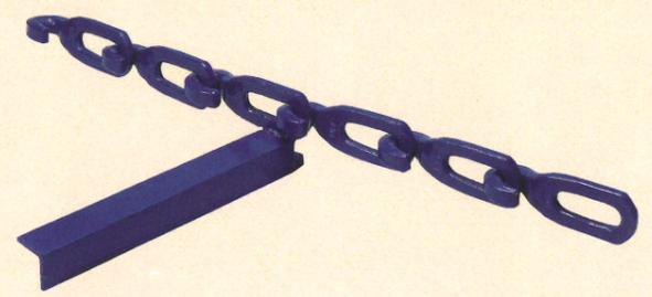
一定間隔でチェーンに組み込まれていて、パドルの底にはヒールが溶接され、損耗を少なくすると共に、移動を円滑にします。リンクは1ピッチ毎に分解され、メンテが容易です。パドルを更に永持ちさせるため、排溝にレールを埋設してチェーンの移動を軽くし、騒音を小さくしています。(別注)
