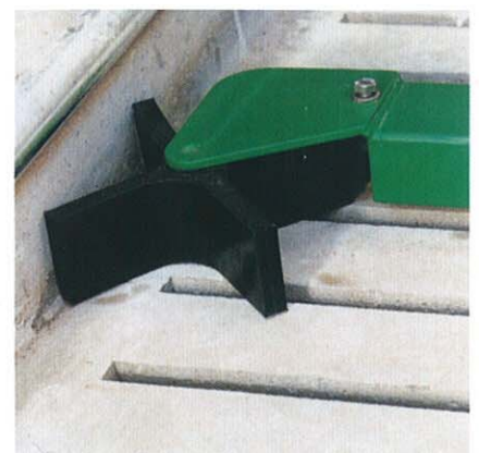
グリッドスクレーパはゴムローターが回転しながら進みます。そのため側面のガイドは不要です。
