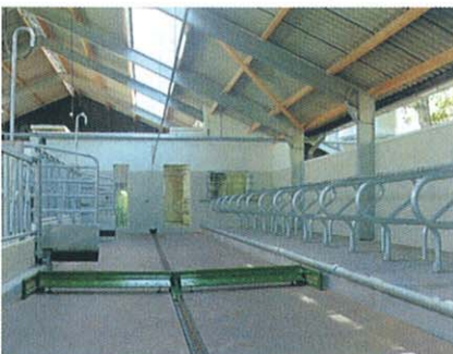
後進時は羽の部分を開けて後部へと進む
