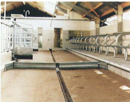
前進時のスクレーパは閉まった状態で、コンビスクレーパは糞尿を前部へとあつめて進む
