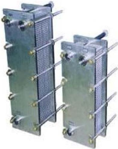
プレートクーラーは、温度の異なる2種類の液体間で熱を移動させるために使われる装置です。
